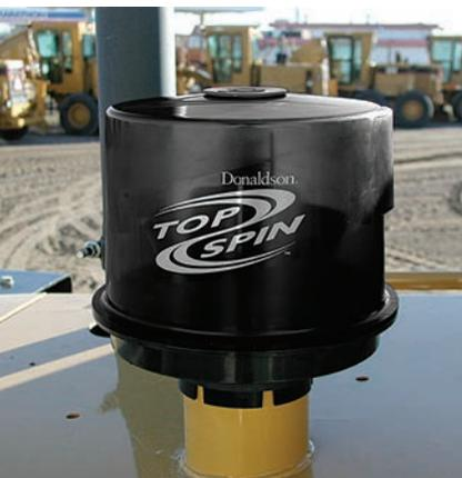
Donaldson TopSpin, montiert auf einer Planierraupe. Der aerodynamisch gestaltete Staubvorabscheider besteht aus leichtem, robustem sowie korrosionsfreiem Material und ist unter einer Vielzahl von Wetter- und Betriebsbedingungen einsetzbar.
